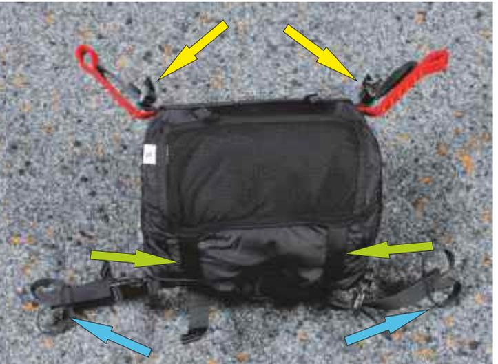
9. Durch verkürzen der Gurte kann der Rettungsfallschirm komprimiert werden (grüne Pfeile).
