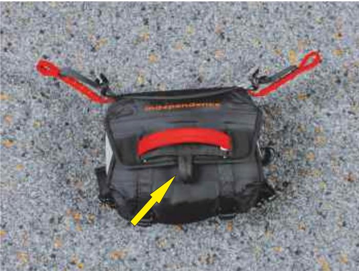
8. Obere Verschlussklappe schließen und mit den Splinten des Auslösegriffes sichern. Griff unter die Griffabdeckung stecken und Packschnüre entfernen. Darauf achten, dass die Griff-Innencontainerverbindung (Pfeil) genügend lang ist, damit bei der Auslösung die Splinte freigegeben werden. Die Packung, ggf. Kompatibilitätsprüfung im Packnachweisheft vermerken!
